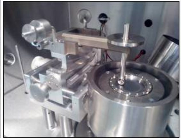
Figure 2 : Vue du contact entre le pion (partie sup.) et le disque (partie inf.)
